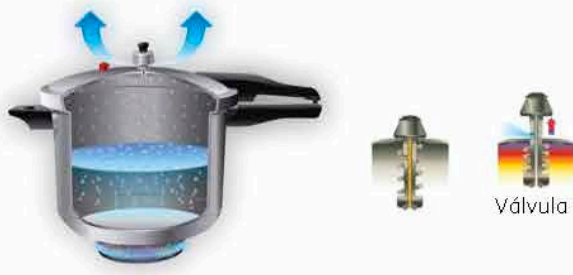
2.36 Funcionamiento de una olla de presión.
