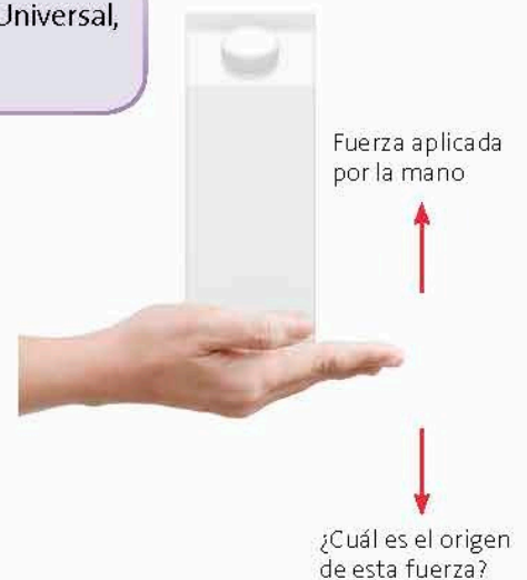
3.13 El peso es la fuerza con la que la Tierra atrae los objetos.
