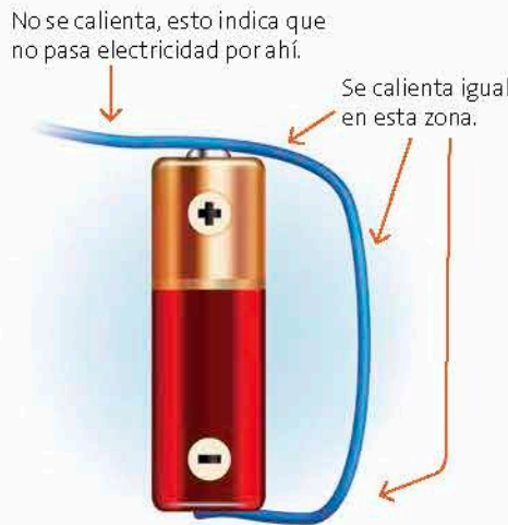
1.33 Pila con cable de nicromel.
