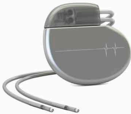
3.54 Los marcapasos funcionan con una batería que debe reemplazarse cada cierto número de años.
