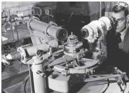
3.40 Para observar las líneas de emisión de alguna sustancia, se usaba (y se sigue usando) un prisma, como lo hacía Newton. Los detalles se aprecian con la ayuda de un microscopio.
