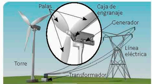
2.43 Esquema del funcionamiento de una central eólica.
