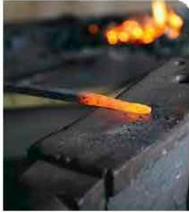
3.39 Cuando el hierro se somete a altas temperaturas, sus átomos liberan energía en forma de luz.
